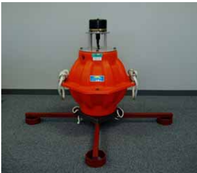
図 3 13 インチ耐圧球に納めた海底局の外観
