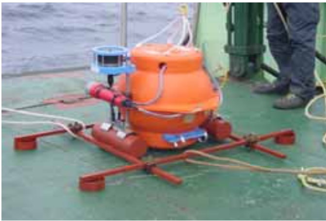
写真4 圧力計（赤い円筒部分）付きの倒立音響測深機（IES）
