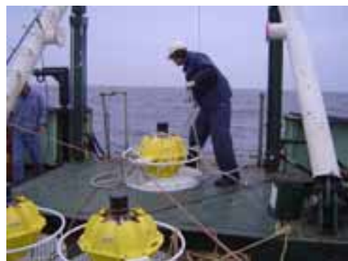
海底局 EJ21 のワイヤ吊り下ろし試験
