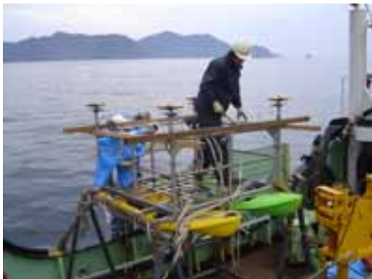
アンテナ保護のために角材取り付け
