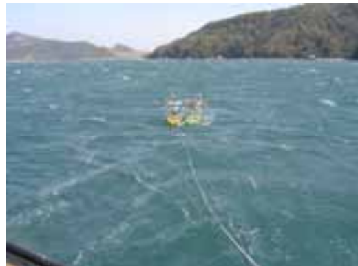
鳥羽港外で小型曳航ブイの GPS 受信試験
