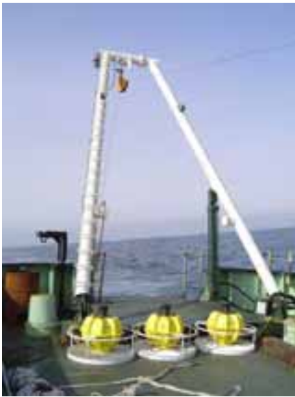
A フレームと音響測距海底局 (東北大学)
