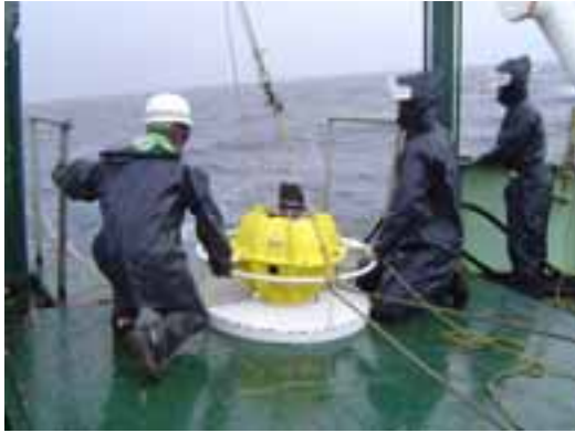
音響測距海底局の設置作業 (D点、EJ20)
