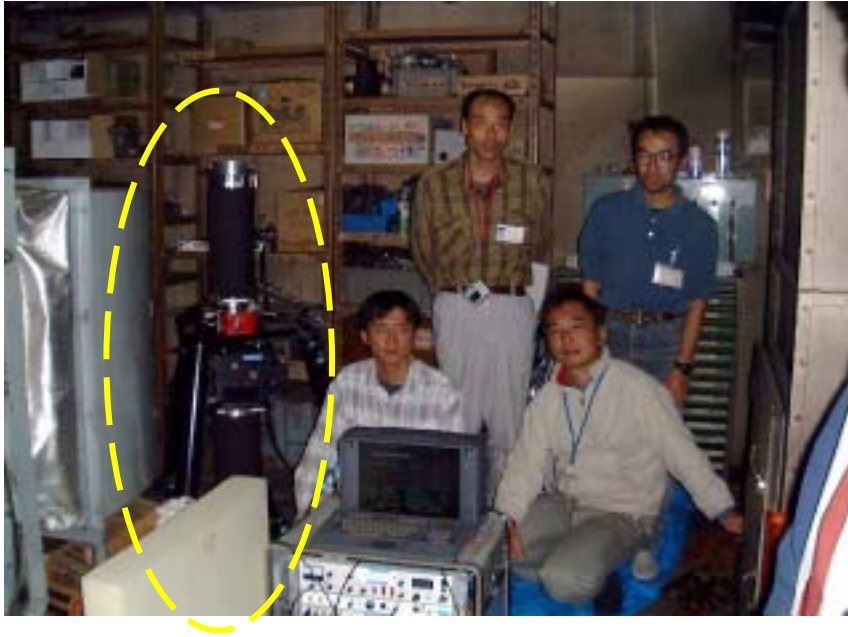
図4：富士山頂測候所における FG5 重力計設置状況（左手）と測候所職員。
