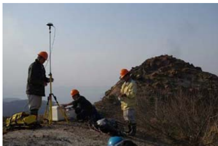
山頂下 100m 地点での GPS と重力観測風景。左から田中（GPS ポール）、西山（重力計）、大久保（記録）。2011 年 4 月。
