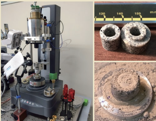
図1 レオメーターによる 摩擦実験
