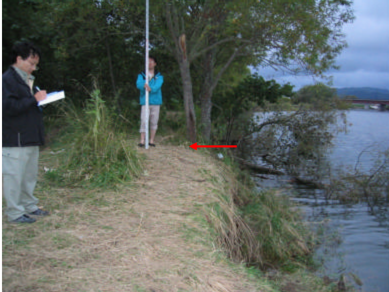
図 156-1 河川右岸に残された津波痕跡．低い草が陸方向に倒れていた．
