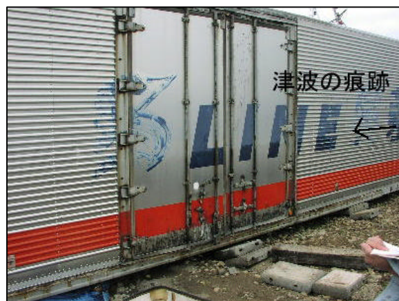
図 130-2 コンテナ壁面の津波の浸水痕
