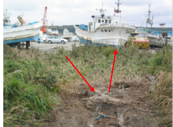
図 115-1 港奥での津波の痕跡. 低い草が倒れており, 海域からの押し波と引き波の双方の向きが読み取れる.
