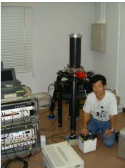
図 1．ハイブリッド重力測定の構成要素．FG5 本体 (最後部の三脚)、同コントローラ (左)、オペレータ、およびその手前にラコステ重力計．
