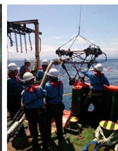
エアガン(3020 cu.in: トリガン×2 + アレイ)
