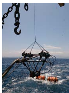
エアガン(3020 cu.in.: トリガン×2 + アレイ)
