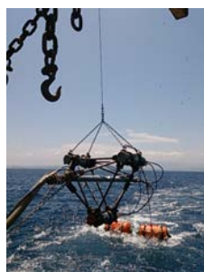
エアガン(3020 cu.in: トリガン×2 + アレイ)
