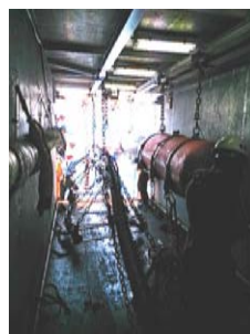
エアガン(3020 cu.in: トリガン×2 + アレイ)
