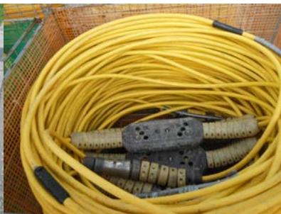
海底敷設型受振ケーブル
