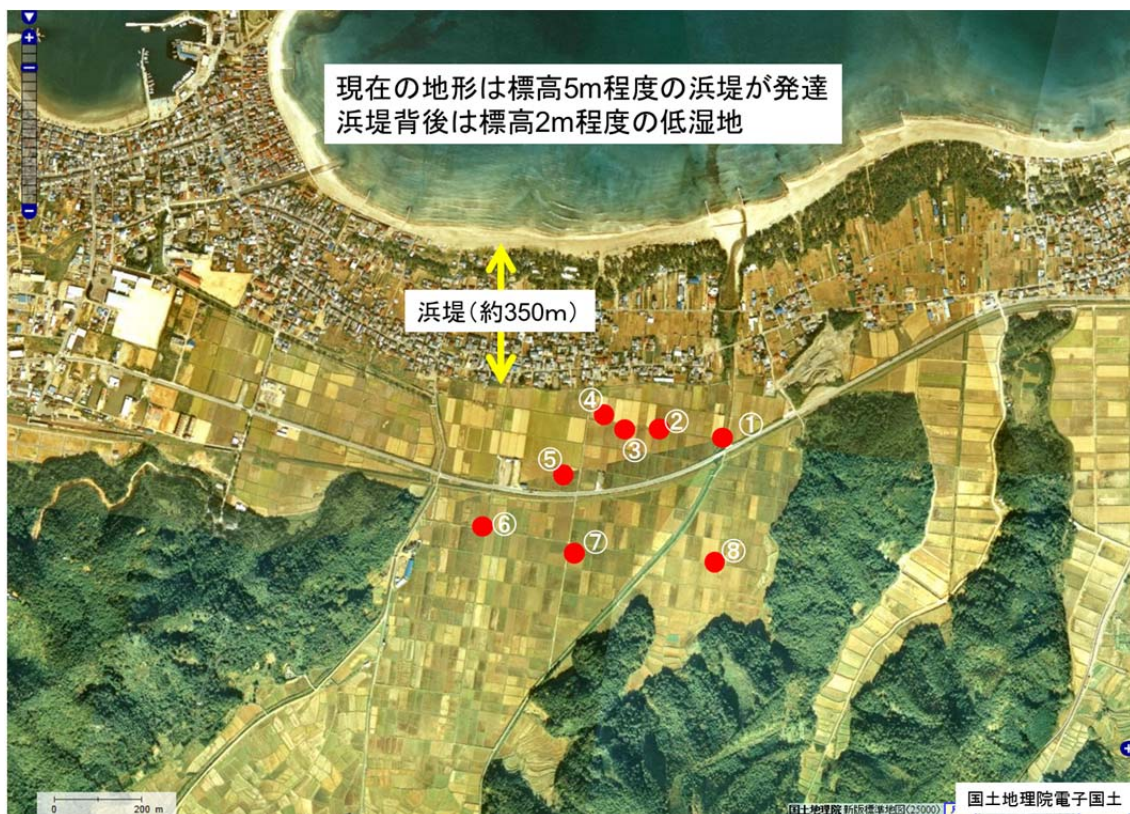
図1 高浜町菌部地区の地形と地層引抜装置による試料採取位置
