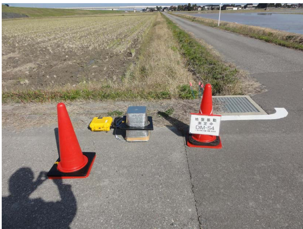
富山平野における微動アレイ探査（射水市 DIM - S アレイ S4 地点）
