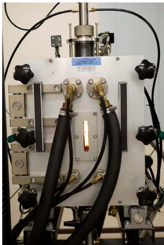
写真 超高温変形実験。万能試験機に超高温雰囲気炉を設置した。
