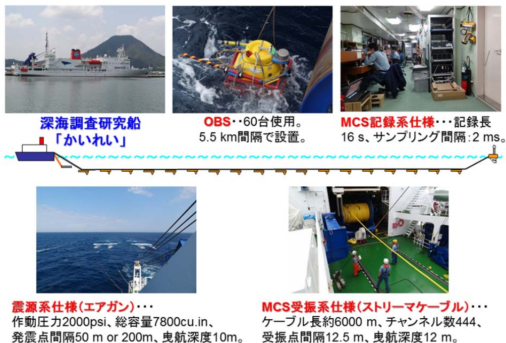
図2 本報告における深海調査研究船「かいいい」の地震探査システムと主なデータ
