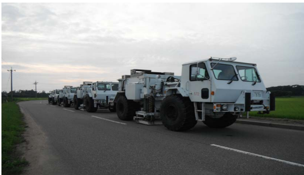
図 8 バイブレータによる発震作業 (VP1037)
