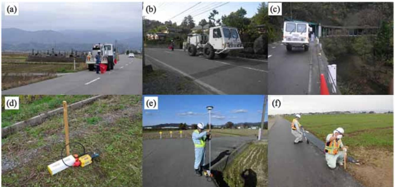
図3 調査観測風景。(a) 福井平野での発震作業、(b) 両白山地山麓部、住宅地での発震作業、(c) 山間部での発震作業、(d) GSR-1の設置の様子、(e) ネットワーク型RTK-GNSS測量の様子、(f) くい打ち作業の様子。
