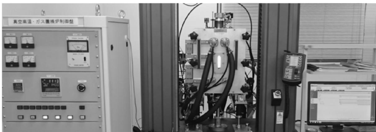
図 12 高温変形試験に用いる万能試験機と高温炉。
