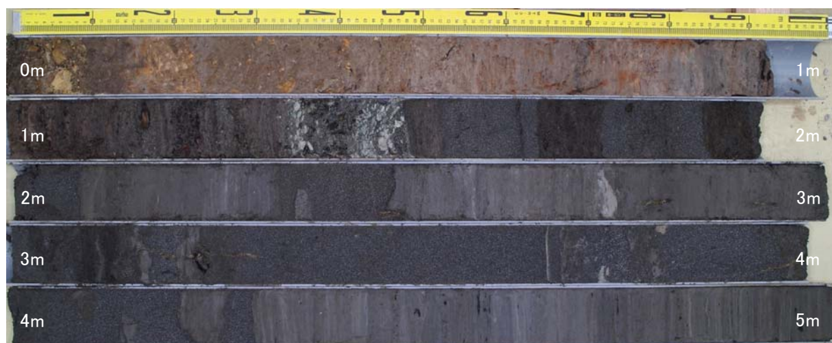
奥尻町ワサビヤチでのボーリング試料の層相（OKU-3：深度 0～5 m） 泥炭層や有機質シルト層中に淘汰のよいイベント砂層が挟在する。
