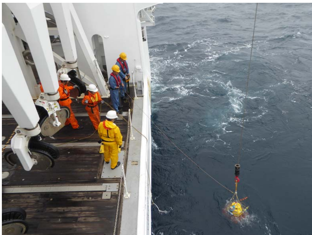
海底広域研究船「かいめい」での海底地震計の投入作業。
