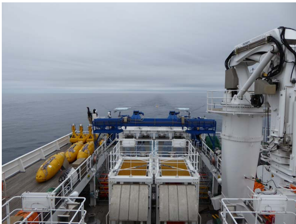
海底広域研究船「かいめい」によるマルチチャンネル反射法地震探査。
