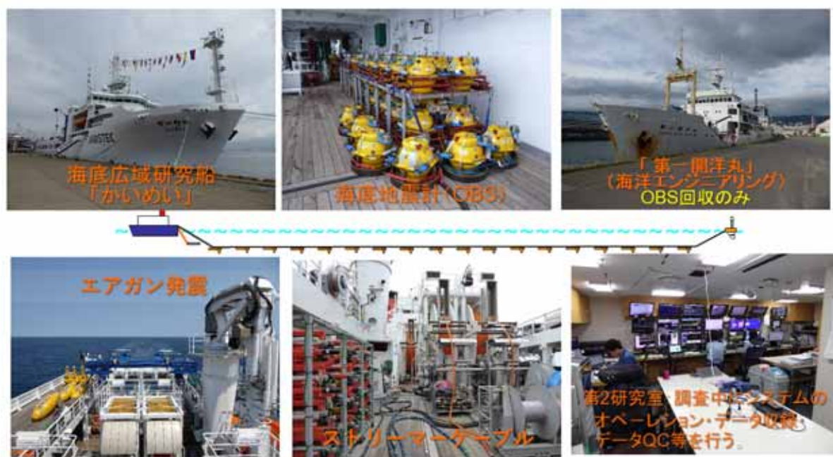
図2 本報告で使用した海底広域研究船「かいめい」の地震探査システムの概要。
