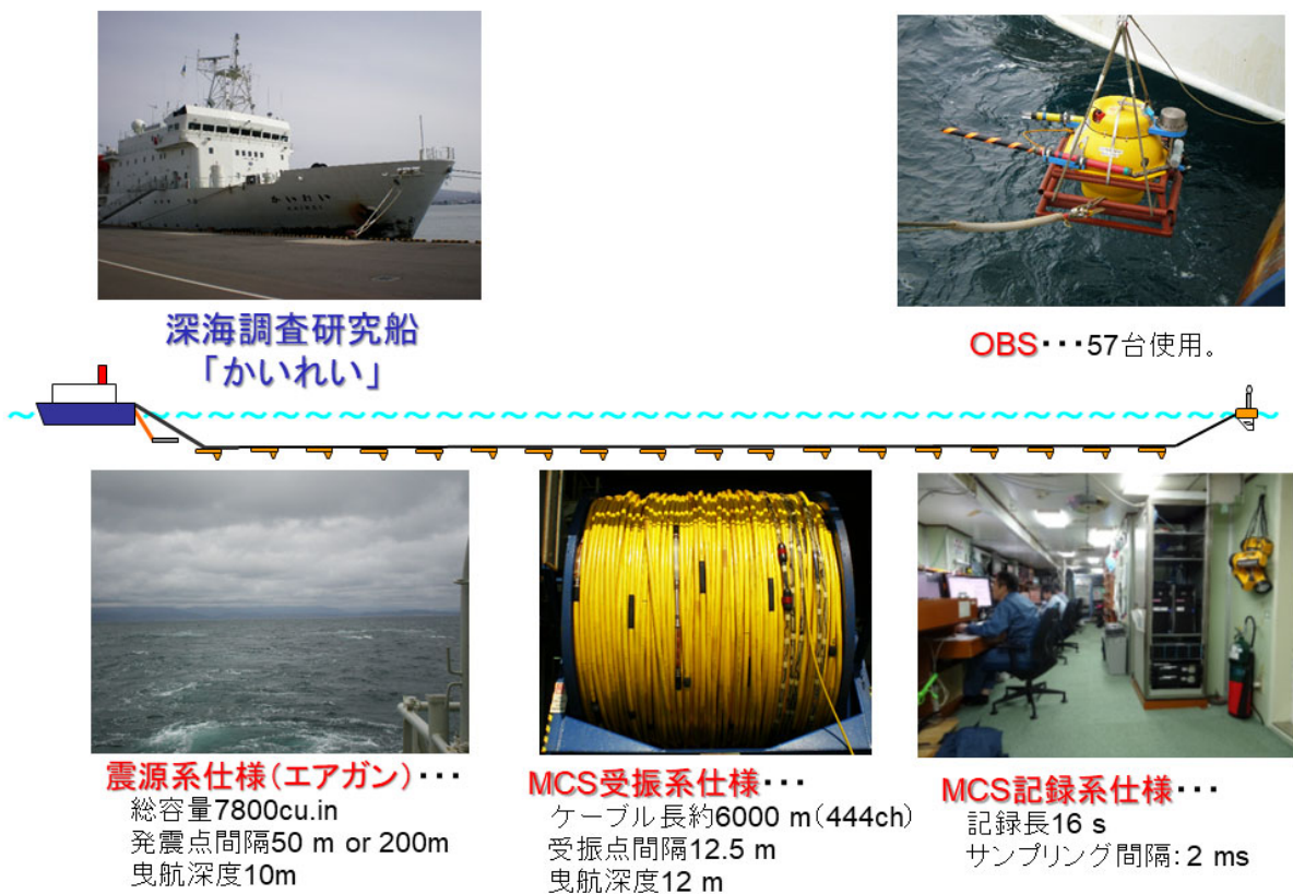
図2 本報告で使用した深海調査研究船「かいれい」の地震探査システムの概要。
