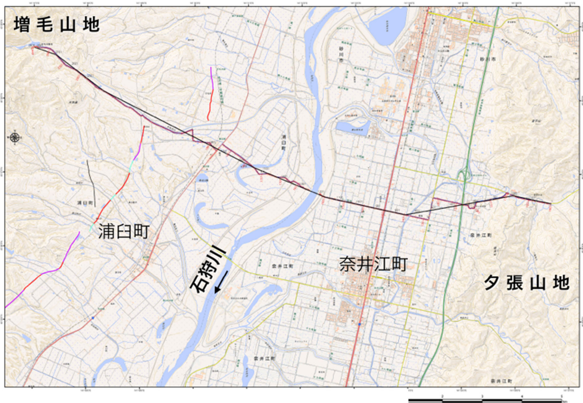
図1 浅層高分解能反射法地震探査（浦臼-奈井江測線）の概略位置図。重合測線を赤線で示す。活断層（赤・紫・青線）の位置は中田・今泉編（2002） 7) に基づく。
