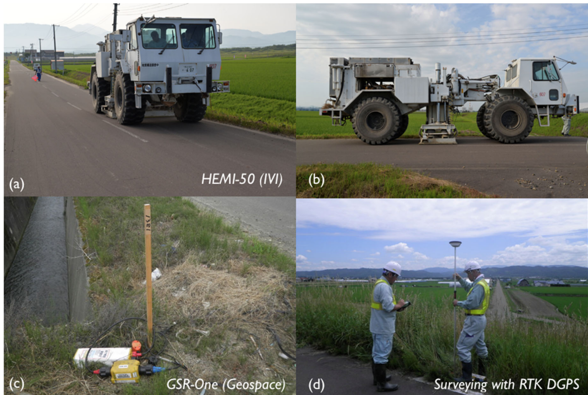
図 2 観測の様子。(a) 大型バイブレーター (HEMI-50) の発振風景。(b) 大型バイブレーターの全景。(c) 地震計および波形収録器 (GSR-One) の設置の様子。(d) RTK ディファレンシャル GPS による測量の様子。
