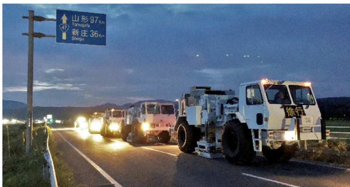
写真 1 大型パイプロサイズによる夜間発震。
