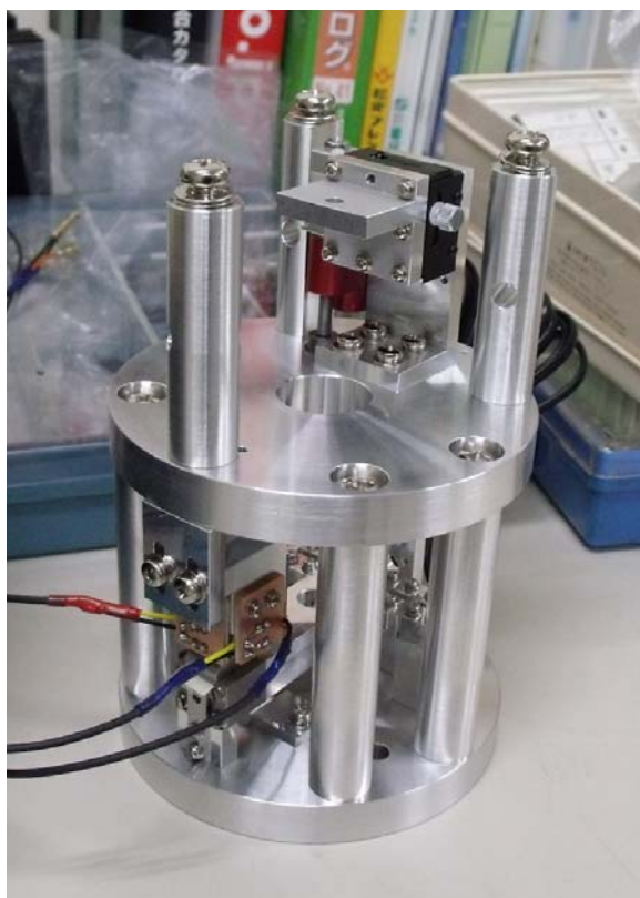
図 19 本計画で製作中の重力センサの外観（仮組） 従来 140 mm であった外径を 100 mm に低減
