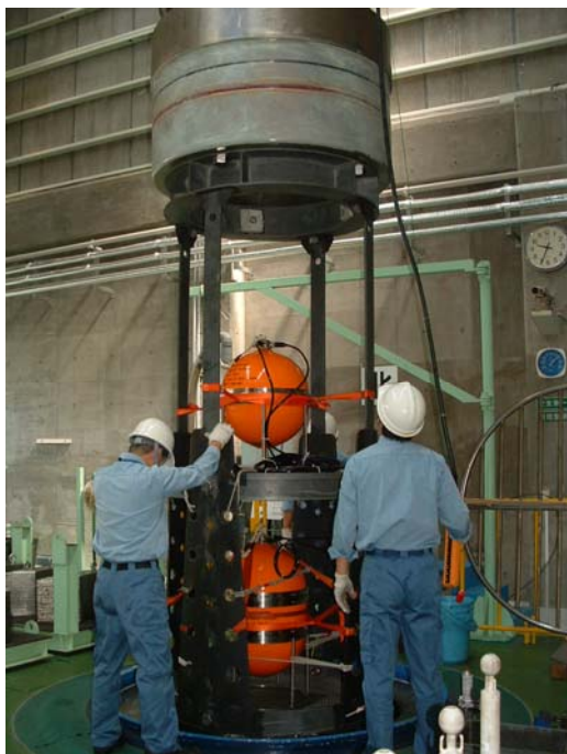
図 12 高圧実験水槽（海洋研究開発機構）による耐圧チタン容器の水密試験
