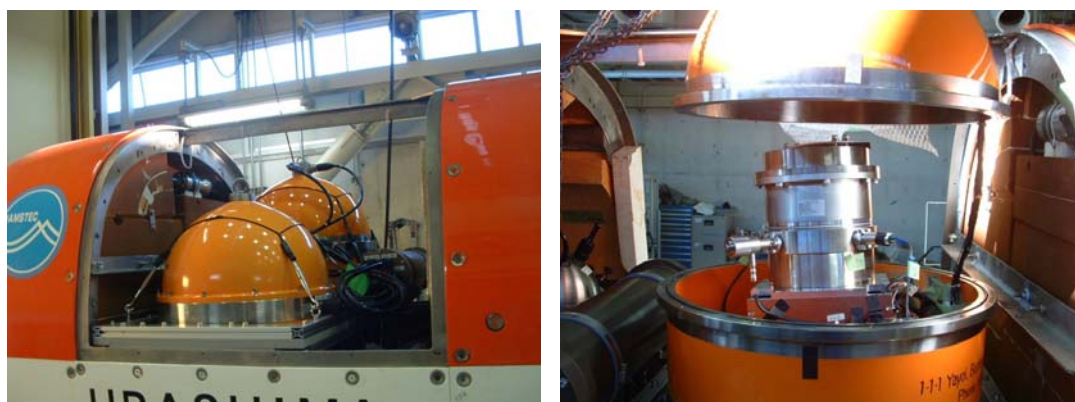
図 15 （左）「うらしま」へ艀装された重力計（手前）および重力偏差計（後方） （右）チタン容器内の XY ジンバル上に搭載された重力偏差計
