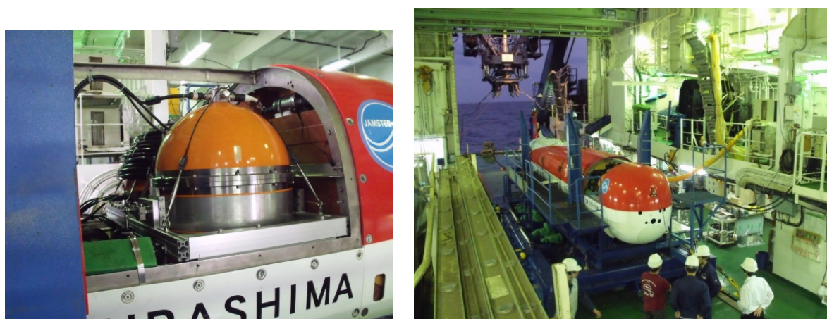
図23 うらしまへ艤装された小型重力偏差計（左）、及び支援母船「よこすか」の格納庫内の様子（右）。
