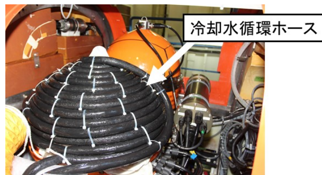
図 7 耐圧容器の上部に冷水循環装置（冷却水を循環させるホースを巻きつけたもの）を取り付けた状態
