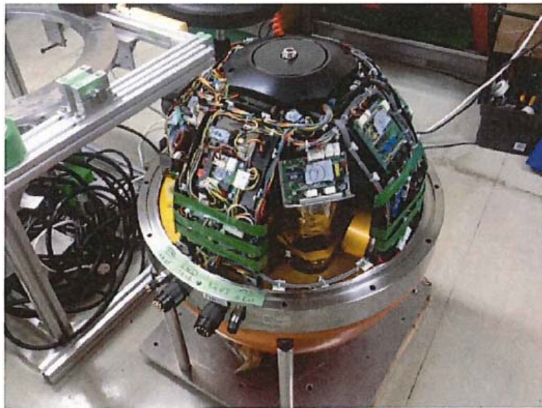
図4 重力計システムの内部構造図（模式図）
