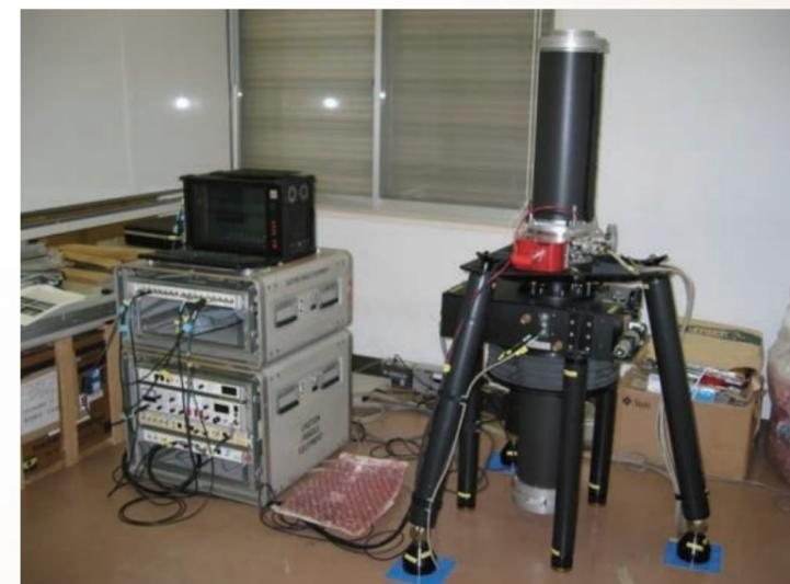
図2 絶対重力計FG5。連続観測がコスト面で非常に難しいため年1回のキャンペーン観測を実施している。重力の絶対値を最も高精度に測れる超精密機器である。
