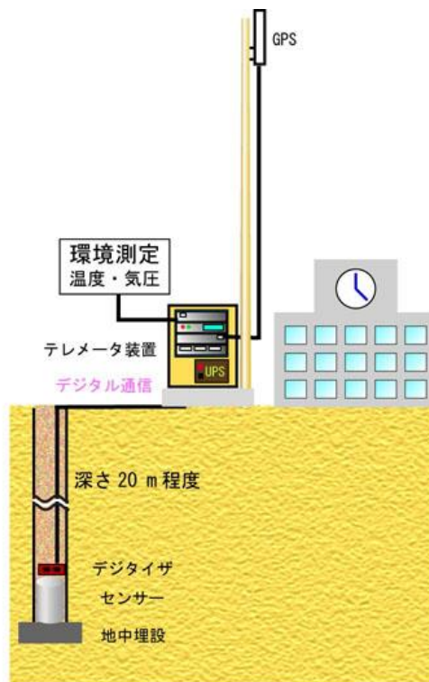
図2 観測点の概要。地下 20m の深さに地震計が設置され、その信号をテレメータ装置が、地震研究所へ 24 時間 365 日連続して送信している。
