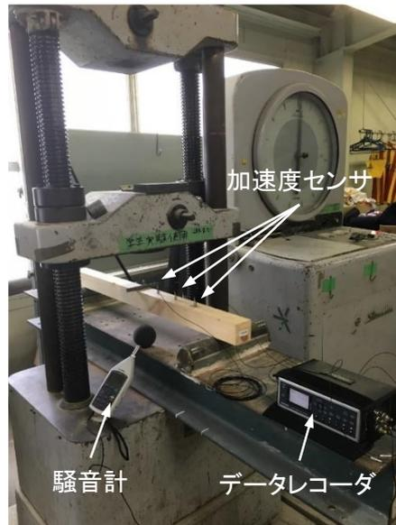
図 46 曲げ破壊試験の様子。
