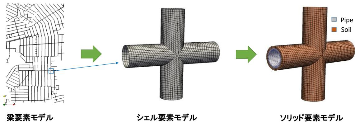
図 30 ライフラインの埋設管ネットワークの階層型モデルの概要。
