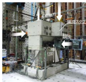
(b)試験体設置状況
