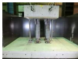
写真1 加力終了後の杭の破壊状況(全体)
