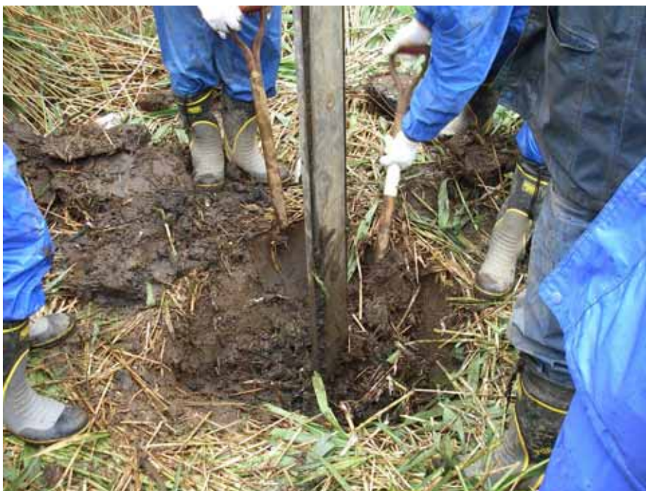
図1. 3m長ハンディジオスライサーを用いた掘削調査風景
