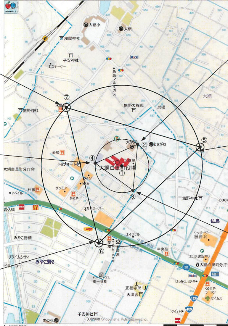
図3. 微動アレイ観測位置配置図(大網白里町)の微動アレイ観測位置設置図面例(R=100, 300mを基本単位としている。)
