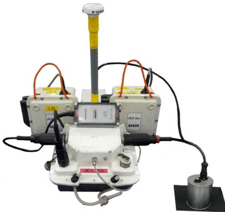
図 9. アナログ出力型 MEMS 加速度センサーによる自然地震観測システムの外観。
