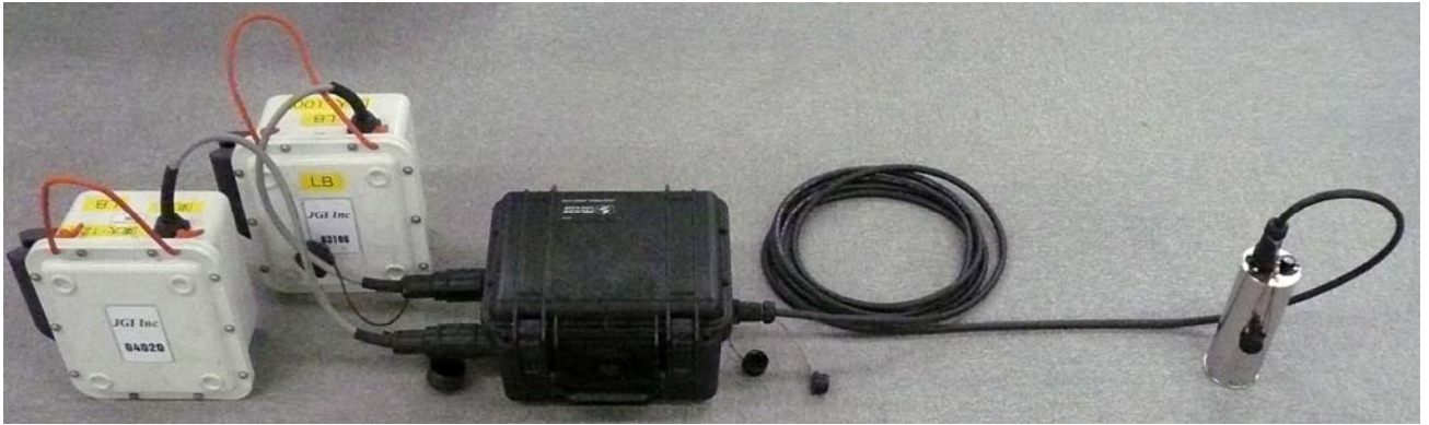
図 11. デジタル出力型 MEMS 加速度計センサーによる自然地震観測システムの外観。
