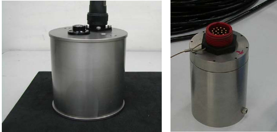
図 8. MEMS 加速度センサーの筐体外観 (左) アナログ出力型 (右) デジタル出力型。
