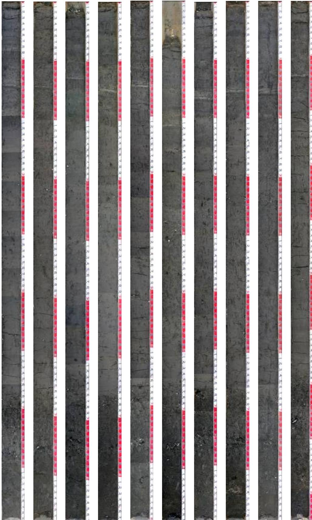
図 5. ジオスライサー採取試料のコア写真。
