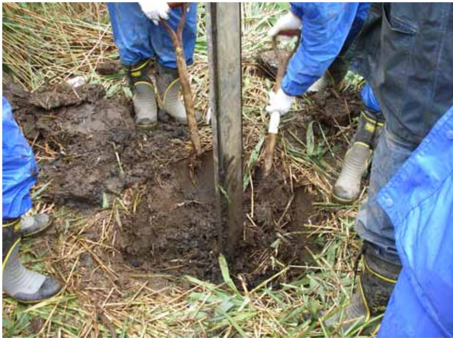
図 3 . 江奈湾における 3m 長ハンディジオスライサーを用いた掘削調査風景。
