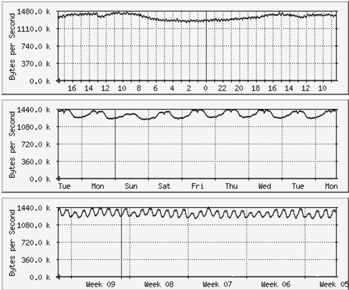
図1 ルータを流れるトラフィック量を示したグラフ。上段より24時間、1週間、1か月のトラフィックを示している。
