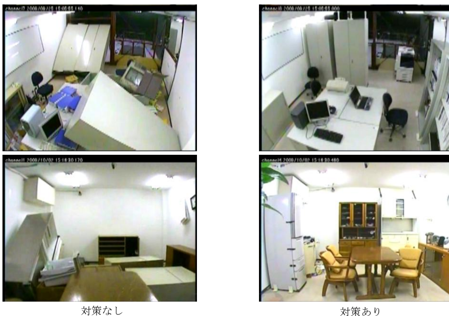
図 4.1- 41 揺れ始めから 80 秒後の室内の様子
