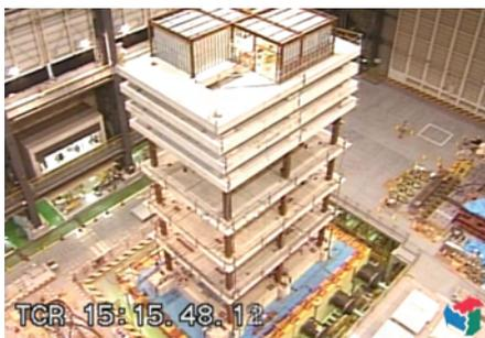
図 5 振動台上の試験体
