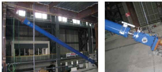
図 8 オイルの圧力を利用するダンパー
