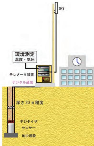
図5 観測点概要（地震計、温度計、気圧計）
