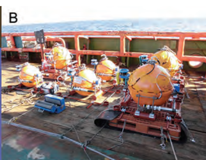
◀数値計算によって求められた1993年北海道南西沖地震に伴う津波の日本海全域の最大水位上昇分布(A)と日本海のリソスフェア構造を明らかにするための長期観測型海底地震計。
