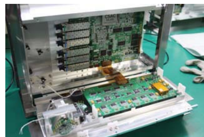
新しいケーブル式海底地震計システムのために開発したエレクトロニクス部。
