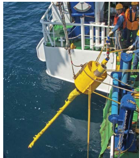
海域での熱流量測定 （この装置を堆積物に突き刺す）
