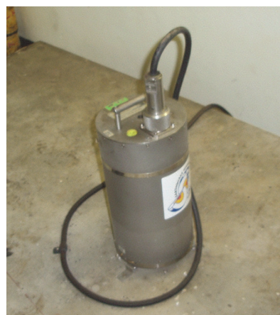
観測で使用している広帯域地震計
