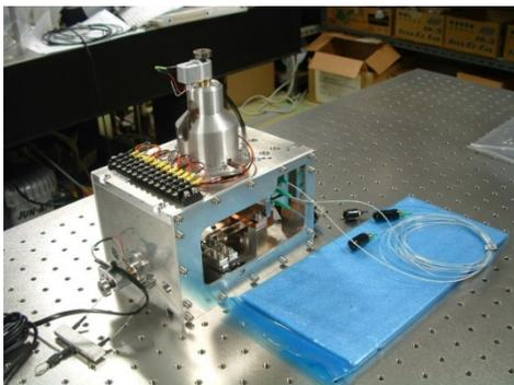
地下深部の高温環境での観測を目指して開発中の広帯域レーザー地震計。惑星探査への応用も検討しています。
