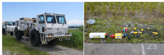
大型バイブレータ震源の稠密発振
