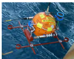
開発した自由落下自己浮上式海底地震計
