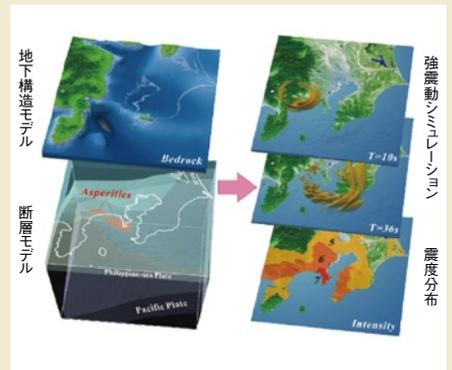
地下構造探査から明らかになった断層の形状や、地下構造などの情報から、地震動がどのように伝わり、各地でどの程度のゆれになるかを高精度で予測する。
