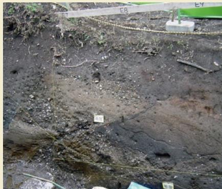
ボーリングやトレンチ調査などによって、断層帯の活動履歴や平均変位速度を求める。写真は2003年に神奈川県が実施したトレンチ調査によって発掘された国府津—松田断層。(撮影:佐藤比呂志)
