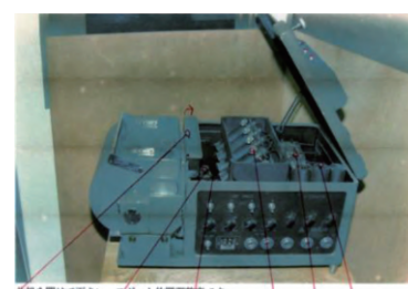
萩原式電磁地震計記録装置 (HES-R) (1956年製造)
