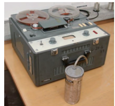
UMP 型電磁地震計・記録装置 (1964年頃使用開始)
