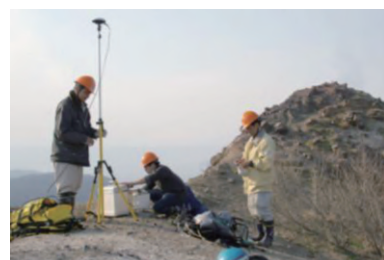
高エネルギー素粒子地球物理学研究センターによる、ミュオグラフィに重力探査とGPS測定を組み合わせる3次元内部構造を描き出すための昭和山での作業
