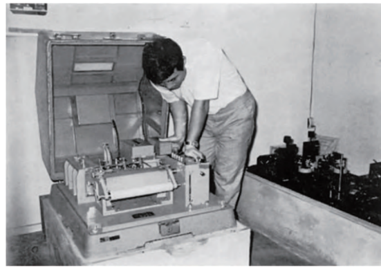
SMAC-A 型強震計（1953年製作）
