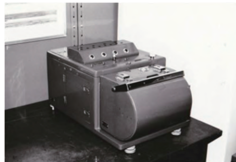
萩原式電磁地震計。左から上下動（HES-V）、水平動（HES-H）、記録計（HES-R）（1956年製作）
