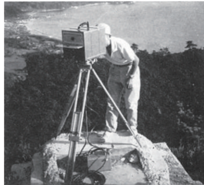
鋸山山頂における光波測距作業（1965年頃）
