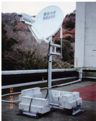
衛星テレメータ式地震観測装置 (VSAT) (1996年開発)
