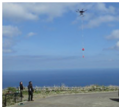
ドローンによる空中磁気測量（離陸時） （2021年）
