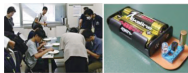
左：2018年地震研究所一般公開での電子工作教室の様子。右：組み立てた「感震器」。オリジナル基板を用意し、小学生でも工作できるよう工夫している
