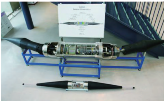
ケーブル式海底地震計 (OBCS) 上段: Geo-TOC 計画用同軸 OBCS (1997年設置) 下段: 栗島用光ファイバー OBCS (2010年設置)
