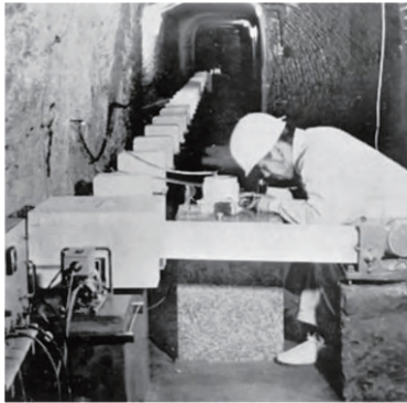
読取式水管傾斜計による測定作業 （1962年頃）
