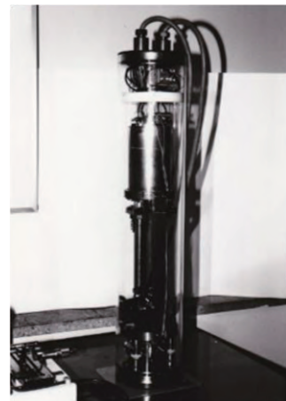
坑井型傾斜計（1979年使用開始）
