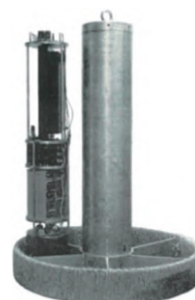
アンカードブイ方式海底地震計（2,000mの海底での実験に成功している）（1965年頃）
