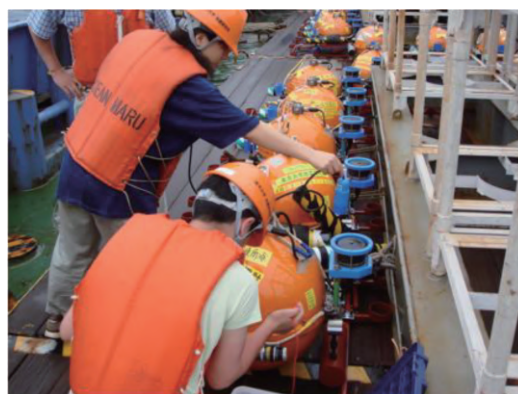
長期観測型自己浮上式海底地震計（LTOBS）の投入前点検作業（2007年）
