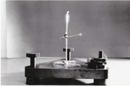
石本式シリカ傾斜計（水平振子傾斜計）（1926年製作）
