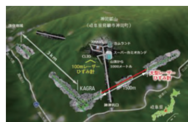
大型低温重力波望遠鏡 KAGRA 坑道内に設置された1,500m長基線レーザーひずみ計（GIF；赤線）
