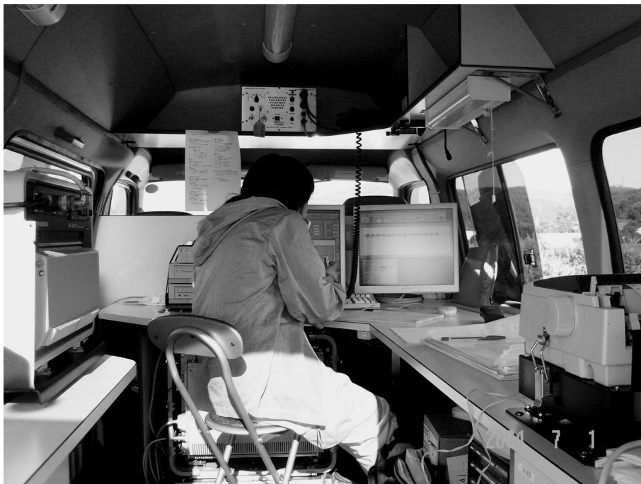
反射法地震探査のオペレーション. 中央制御装置では計測ラインの状況がモニターでき, 震源車の発震と観測ユニットによる受振を統括的に制御する. 観測ユニットは (株)地球科学総合研究所製の GDAPS-4.
