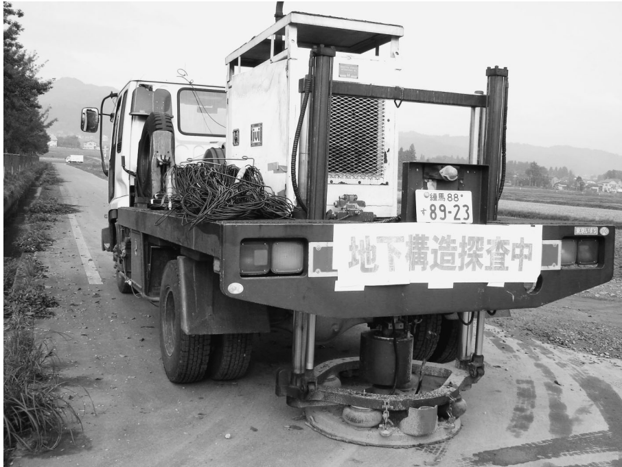
震源車. IVI社 (Industrial Vehicle International) 製の油圧バイブレーター震源 (T15000) を国産の4トントラックにマウントしている.
