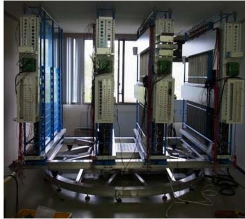
図1 (左) 密度勾配法の原理。(右) 今回製作したミュオン検出器
