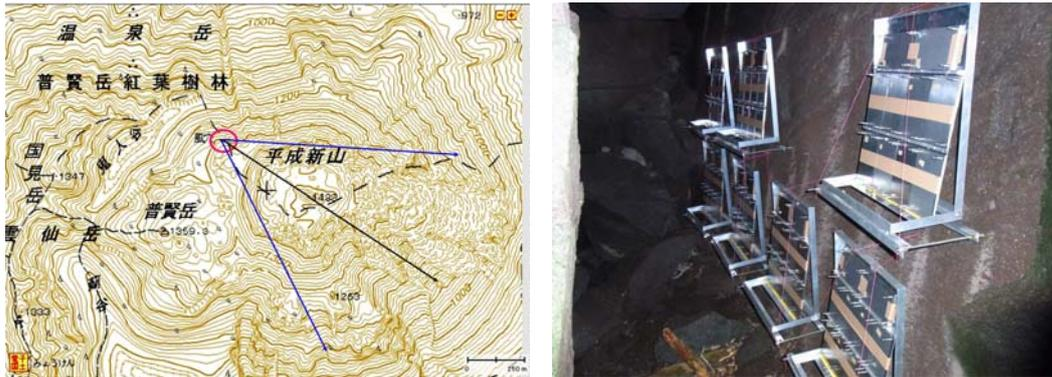
図 2a(左)：雲仙溶岩ドーム(平成新山)と検出器を設置した風穴との位置関係。風穴の標高は約 1300m、ドーム山頂までの距離は約 500m、ドーム山頂との高低差は約 480m である。原子核乾板の開口角は、ドーム中心方向を方位角 0 度として、方位角方向に  $\pm 30$  度、仰角方向に  $0 \sim 30$  度である。
