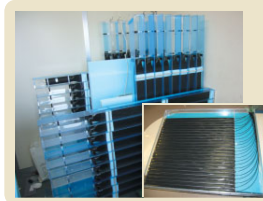
図3 製作中のリアルタイム観測が可能なミュオン検出器
