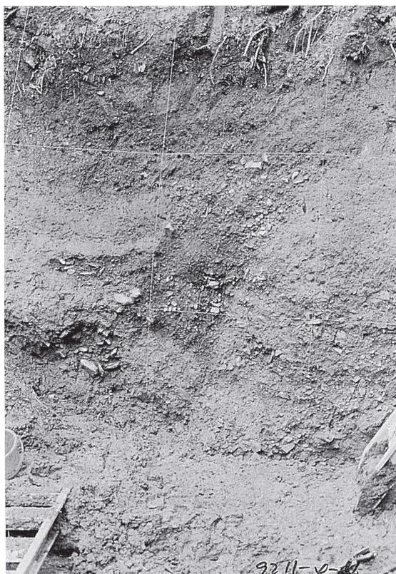
写真 1. 花折断層のトレンチ調査によって出現した断層。断層は黒っぽい表土のすぐ下の地層まで切断されており、花折断層は歴史時代に活動したことが判明した。
