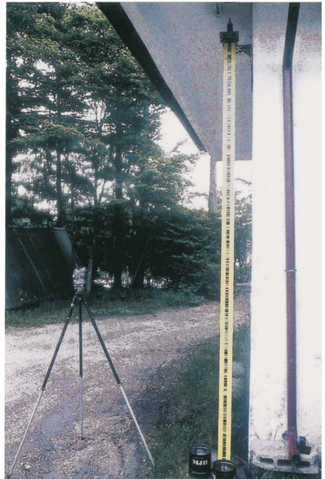
図 3. 標尺の点検. 標尺を立て、前面と側面に糸をつり下げ、ポトラルなどにて標尺の傾きを調整.
