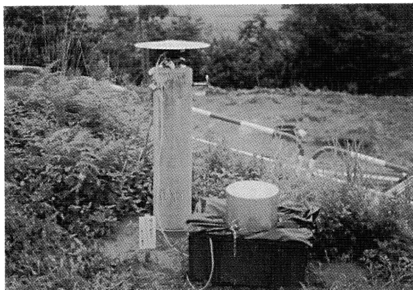
図 5. 刈羽観測点のアンテナ固定柱
