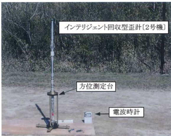
図 3. 磁気方位計 360 度の出力値測定
