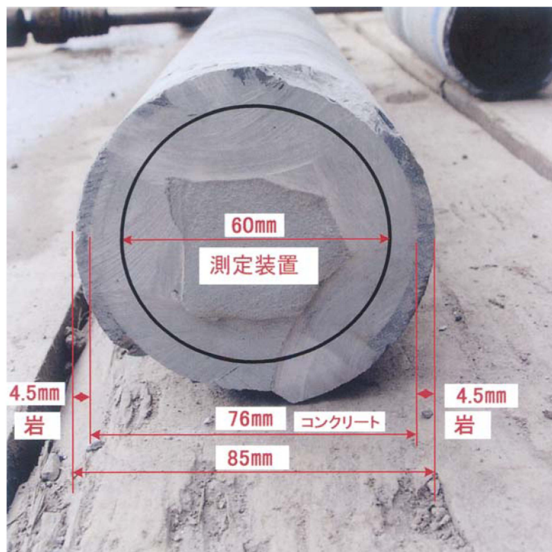
図 10. 509 m ボーリング孔から回収された同芯円のコア（インテリジェント回収型歪計 1 号機使用）
