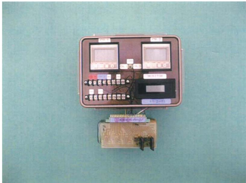
図 2. 自動電圧調整回路 (2チャンネル仕様) の概観. 上は本体で, しきい値設定部 (RX 2408 または RX 2501) と入力モニター (XE-1132) および入力端子. 下はゼロ調整部 (XE-7052BP とオペアンプなど) の基板.
